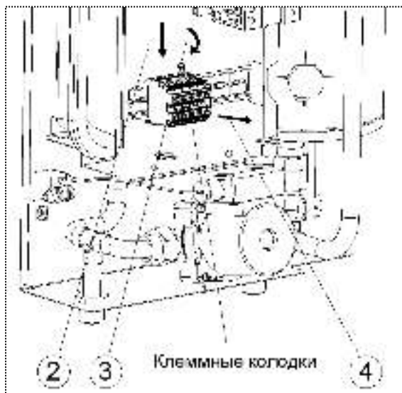
Рисунок 18. Замена клеммных колодок
